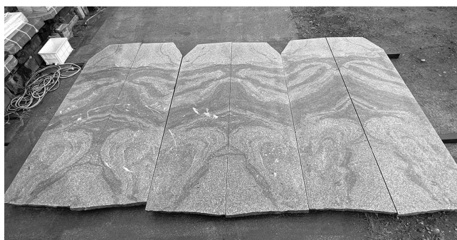
上段から順に、真壁石の丁場、神永石材のダイヤモンドビーズソーにセットされた桜川まかべ石の原石、ブックマッチ状に並べた敷き並べ検品のようす（いずれも潮田石材ホームページより）
